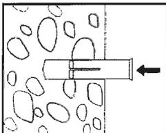
Der Dübel ist von Hand bzw. durch Schläge mit einem Hammer mindestens bündig mit dem Verankerungsgrund zu setzen.
