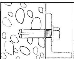
Bauteil befestigen, hierbei darf das angegebene maximale  $T_{inst}$  nicht überschritten werden.
