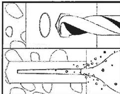
Bohrloch erstellen und das Bohrmehl durch Ausblasen aus dem Bohrloch entfernen.
