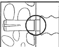
Der Dübel ist richtig verspreizt, wenn das Spreizwerkzeug auf dem Dübelrand aufliegt und die Prägung (nicht bei Verwendung des Maschinensetzwerkzeuges) am Dübelrand sichtbar ist.
