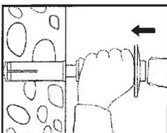
Durch das Einschlagen des Spreizstiftes mit dem Setzwerkzeug ist der Anker zu verspreizen.
